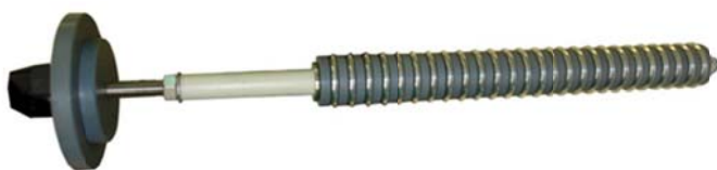
Haltevorrichtung zum Ätzen der Dicing Blades mit AL-Grundkörper für je 27 St. montiert (links); Einzelteile (rechts)
