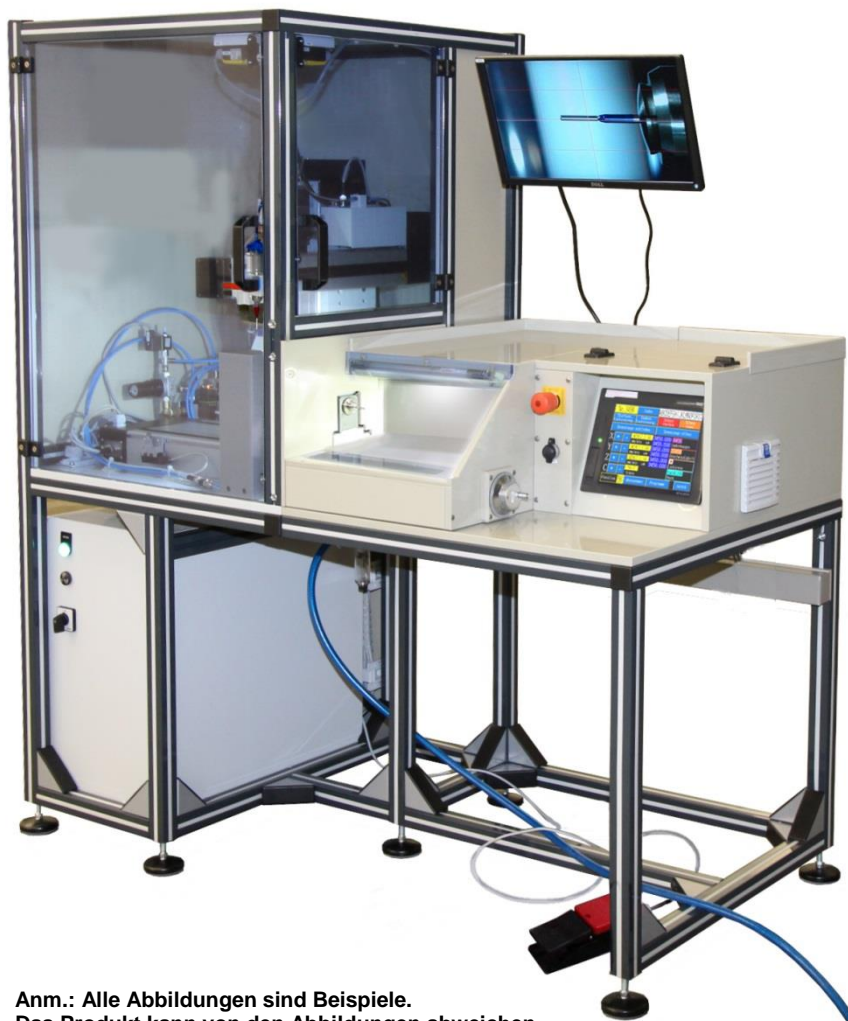
Lackiereinheit mit Drei-Achsen-Führung und druckbasiertem Farbdosiersystem
