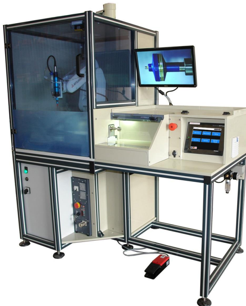
Lackiereinheit mit 6-Achsen-Roboter und volumetrischem Dosiersystem
