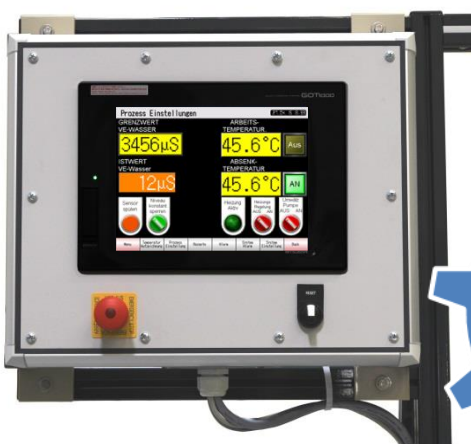
Einstellung und Überwachung der Bad- und der Prozessparameter mittels Touchscreen-Bedienterminal (Steuerung PBS-845/001)
