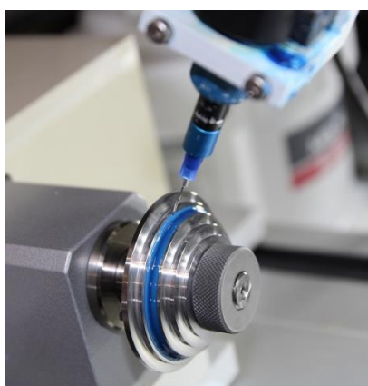
Schutzlackierung einer Schleifscheibe. Die freie Positionierung der Farbauftragung erlaubt die Lackierung von komplex geformten Teilen mit Hinterschnedungen.
