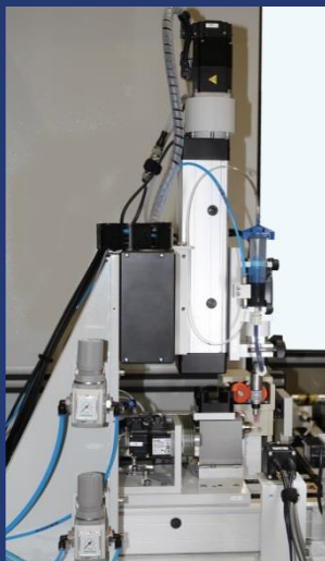
Lackiereinheit mit Vier-Achsen-Führung und volumetrischem Dosiersystem VDS-145
