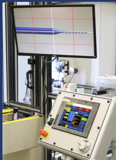
Monitor und Touchscreen-Bedienterminal zur Überwachung und Steuerung des Prozesses
