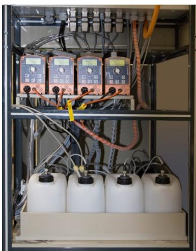
Innenansicht der PRS: Dosierpumpen und Reservoirs für die Regulierchemie des Beschichtungsbades
