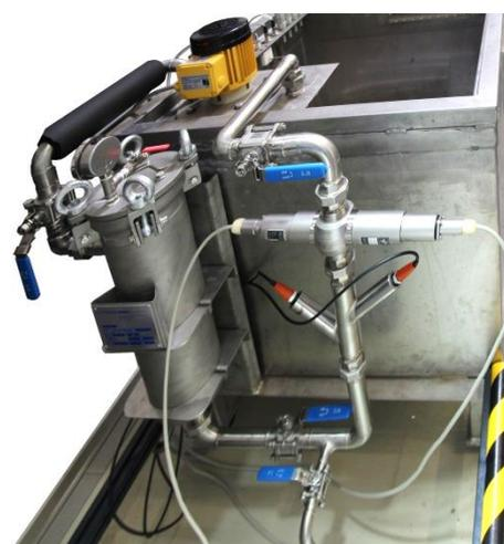
Beutelfiltereinheit und Sensoren zur Überwachung des Beschichtungsbades
