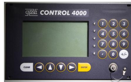
Bedientableau für anodischen Wannenschutz (Protectostat)
