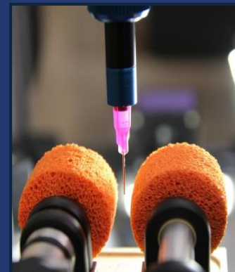
Reinigungseinrichtung für Dosiernadel
