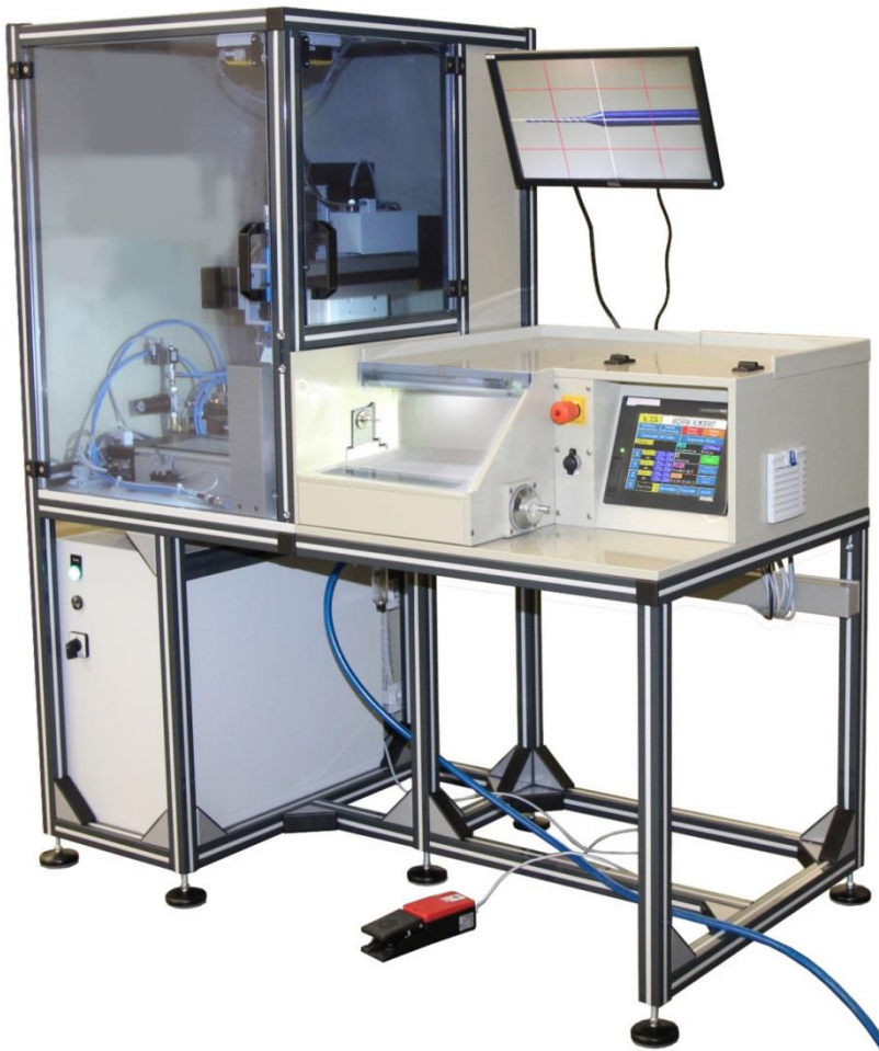
Lackiereinheit mit Vier-Achsen-Führung und volumetrischem Dosiersystem VDS-145
