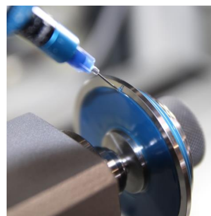
Schutzlackierung einer Schleifscheibe. Die freie Positionierung der Farbauftragung erlaubt die Lackierung von komplex geformten Teilen mit Hinterschnedungen.
