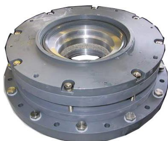
Rotationsbeschichtungsvorrichtung mit montierter Negativform (max Formaußen- \varnothing 250 mm)
