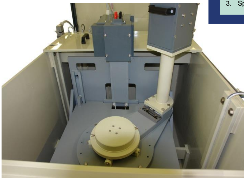
Hebe- und Senktisch mit montierter Rotationseinrichtung und Bajonettaufnahme in der Beschichtungswanne montiert.
