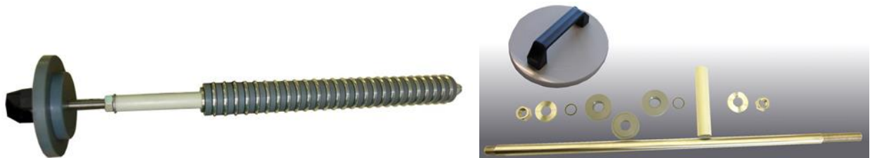
Haltevorrichtung zum Ätzen der Dicing Blades mit AL-Grundkörper für je 27 St. montiert (links); Einzelteile (rechts)
