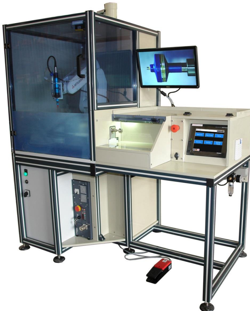
Lackiereinheit mit 6-Achsen-Roboter und volumetrischem Dosiersystem
