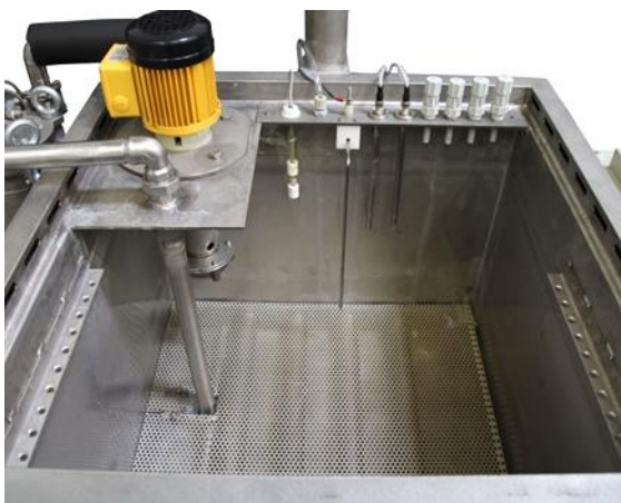
Innenansicht der Beschichtungswanne
