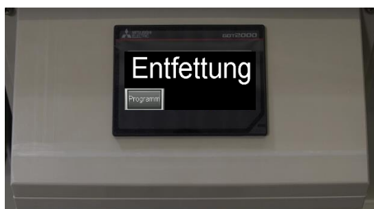
Prozessbedientableau zur Prozesssteuerung (Beispiel: Entfettung)
