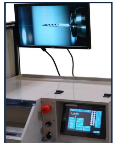
Monitor zur Kontrolle der Lackierung
