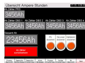
PRS 的终端操作触摸屏（电解液稳定性）
