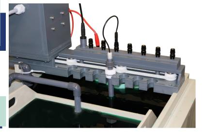
安装在电镀站中的旋转装置,带有一个磨辊的 接触夹具
