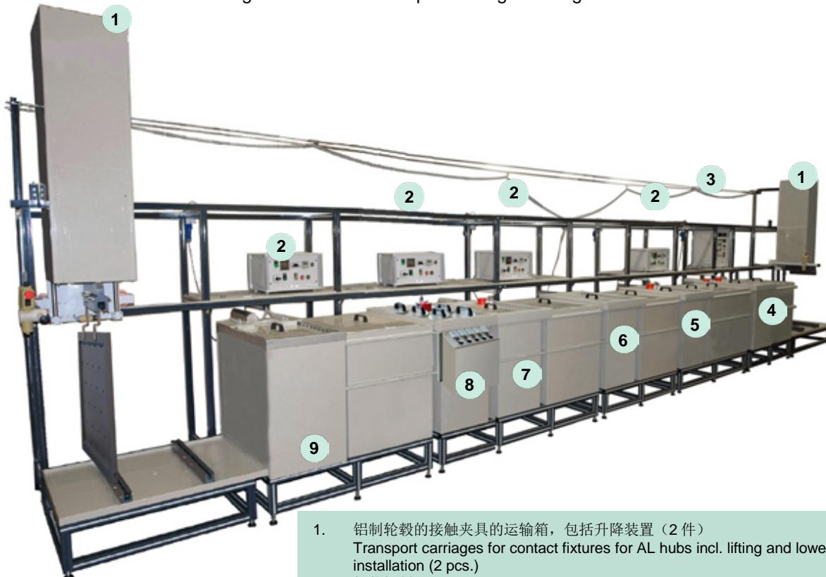
1. 铝制轮毂的接触夹具的运输箱, 包括升降装置 (2 件)
