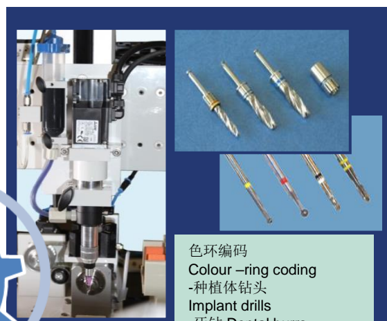
带有漆料容量配积系统的编码装置 Coding unit with volumetric paint dosing system VDS-145
