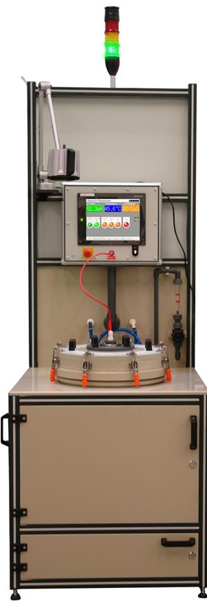
旋转式凹版电镀装置 RBE Rotational reverse-plating unit RBE - 一个带有盖子的旋转电镀槽 1 rotational plating vessel with lid - 带有膜片阀的流量计，用于调节电解液流量 Flow meter and diaphragm valve for electrolyte flow regulation - 旋转 最大 500 转每分 Rotation max. 500 rpm - 一个旋转式凹版电镀调控装置 RBS 10A-45/0011 Rotational reverse-plating control RBS 10A-45/001
