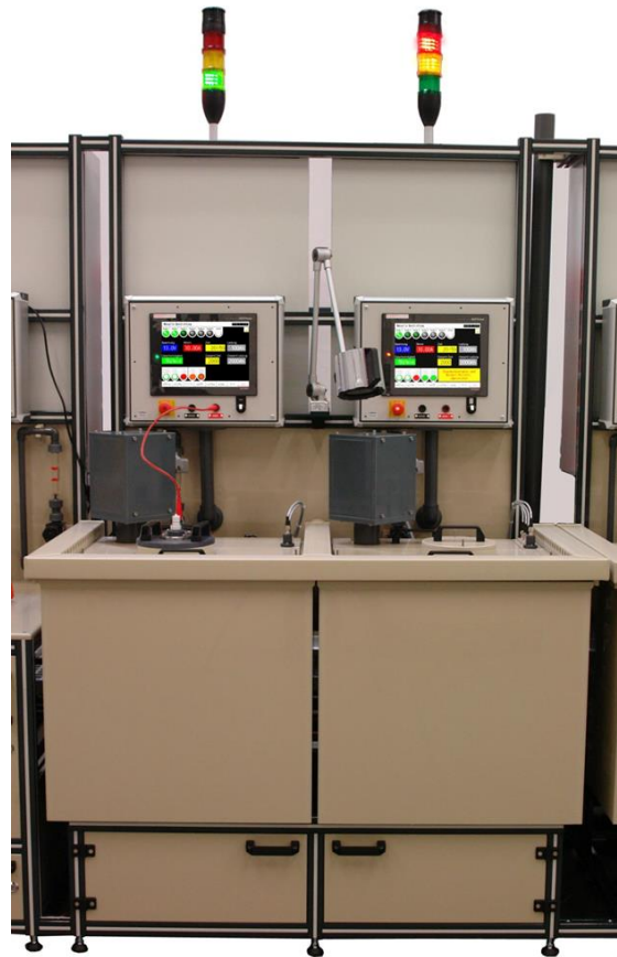
镀厚镍装置 DVE 2/56-56-50/001 Thick-nickel plating unit DVE 2/56-56-50/001 - 2 个带有周边抽吸装置的电镀槽 2 electro-plating tanks with rim exhaustion - 2 个水平旋转装置 2 horizontal rotation units - 2 个镀厚镍调控装置 DVS 10A-45/0012 thick-nickel plating controls DVS 10A-45/001 带有内置驱动调控装置 with built-in motor control
