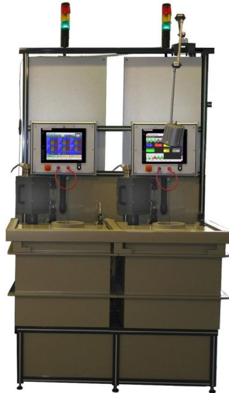
镀厚镍装置 DVE 2/56-56-50/001 Thick-nickel plating unit DVE 2/56-56-50/001 - 2 个带有周边抽吸装置的电镀槽 2 electro-plating tanks with rim exhaustion - 2 个水平旋转装置 2 horizontal rotation units - 2 个镀厚镍调控装置 DVS 10A-45/001 2 thick-nickel plating controls 带有内置驱动调控装置 with built-in motor control
