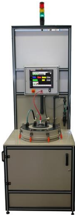
旋转式凹版电镀装置 RBE 1/45-49/001 Rotational reverse-plating unit RBE 1/45-49/001 - 一个带有盖子旋转电镀槽 1 rotational plating vessel with lid - 带有膜片阀的流量计，用于调节电解液流量 Flow meter and diaphragm valve for electrolyte flow regulation - 旋转 最大 500 转每分 Rotation max. 500 rpm - 一个旋转式凹版电镀调控装置 RBS 10A-45/0011 rotational reverse-plating control RBS 10A-45/001
